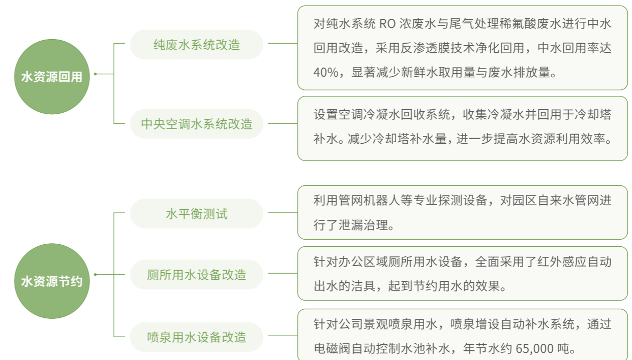
时代电气节水措施
